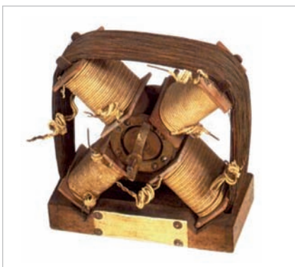
Obr. 4 Štvrtý model Ferrarisovho striedavého motora (1886)
