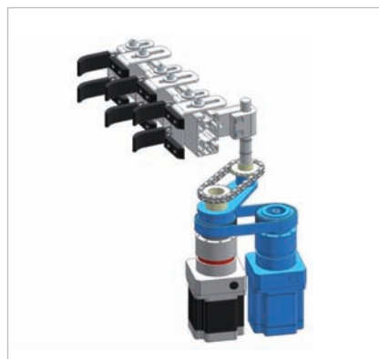
Obr. 5 Elektronická vačka, ukážka spriahnutia dvoch krokových motorov
